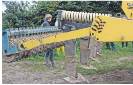
Mit einem Tiefengrubber lassen sich Verdichtungen im Unterboden auflockern,
