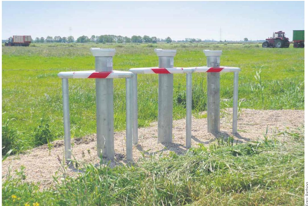
NLWKN Aurich: Dreifach-Messstelle zur Probenahme in unterschiedlichen Grundwassertiefen.
