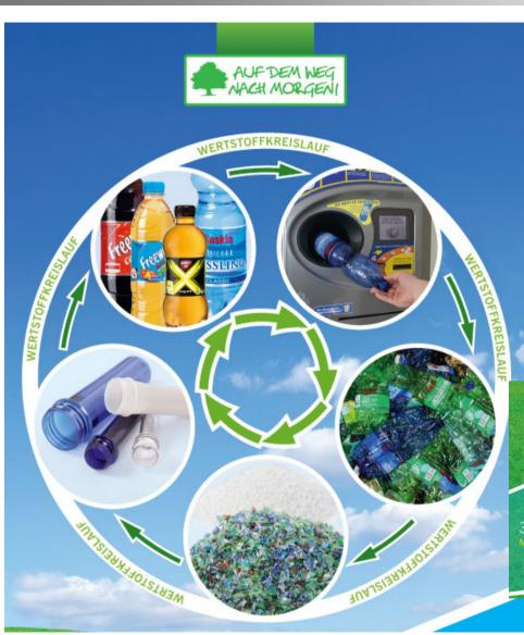
PET-Flaschenrecycling: getrennter Stoffstrom, geringe Verunreinigung
