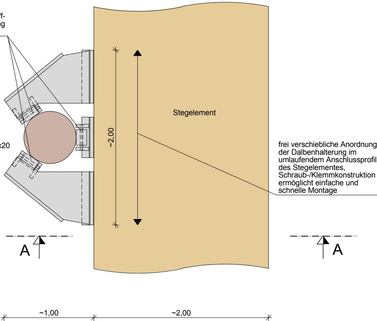
Schematische Darstellung der Dalbenhalterung, Festlegung der endgültigen Abmessungen entspr. den statisch-konstruktiven Erfordernissen
