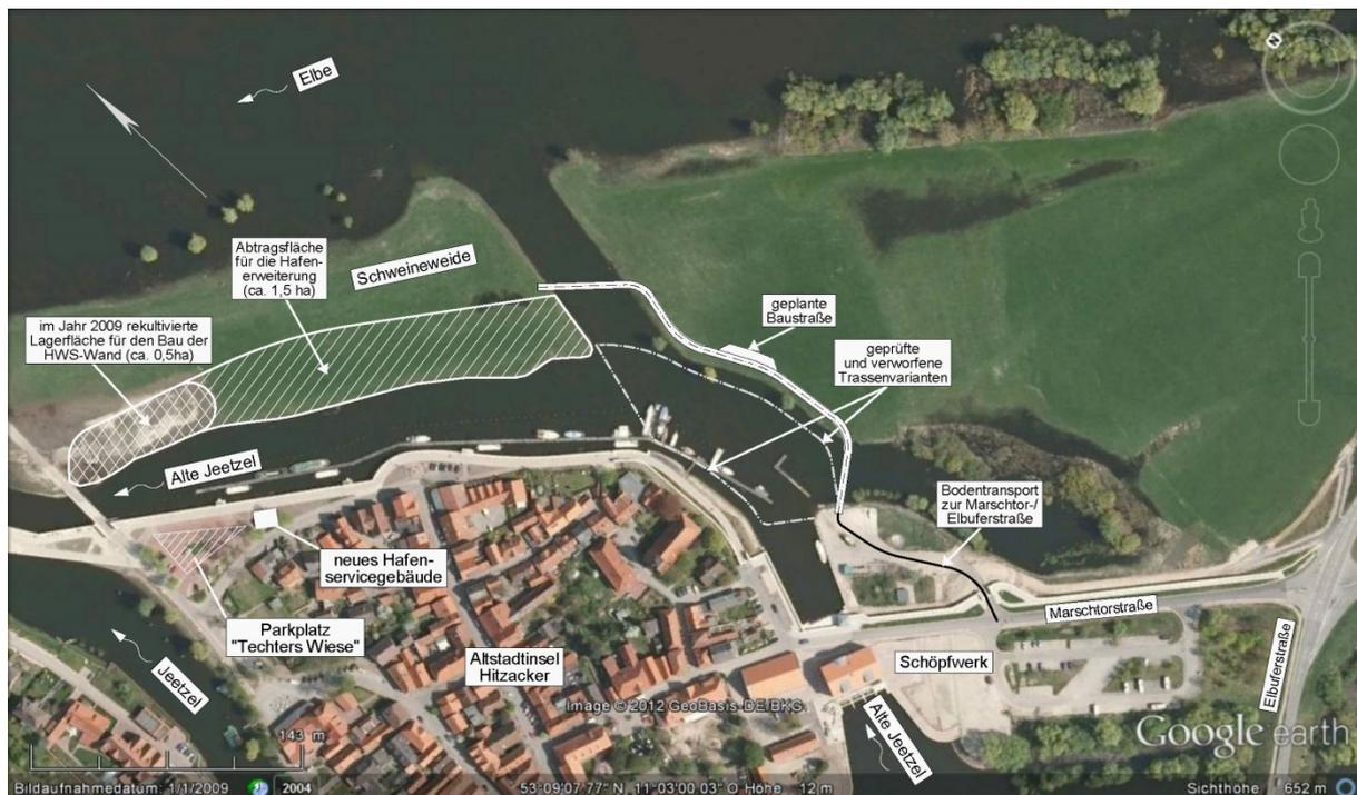
Die beiden Dämme werden mit dem Aushubboden aus der Hafenbeckenerweiterung hergestellt. Das Volumen der Dämme beträgt bei einer Sohlhöhe des Hafenbeckens von 7,50 m bzw. 7.80 m und einer Gradienten der Baustraße zwischen 11,80 m ü. NN und 12,00 m ü. NN rund 3.750 m<sup>3</sup>. Die Böschungen der Dämme sind mit einer Neigung von 1 : 2,5 herzustellen.
