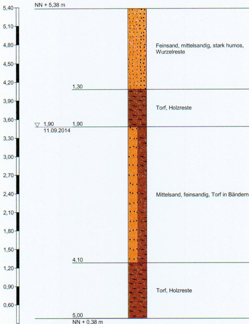
Ruhewasserstand durch Zufall des Bohrloches nicht möglich
