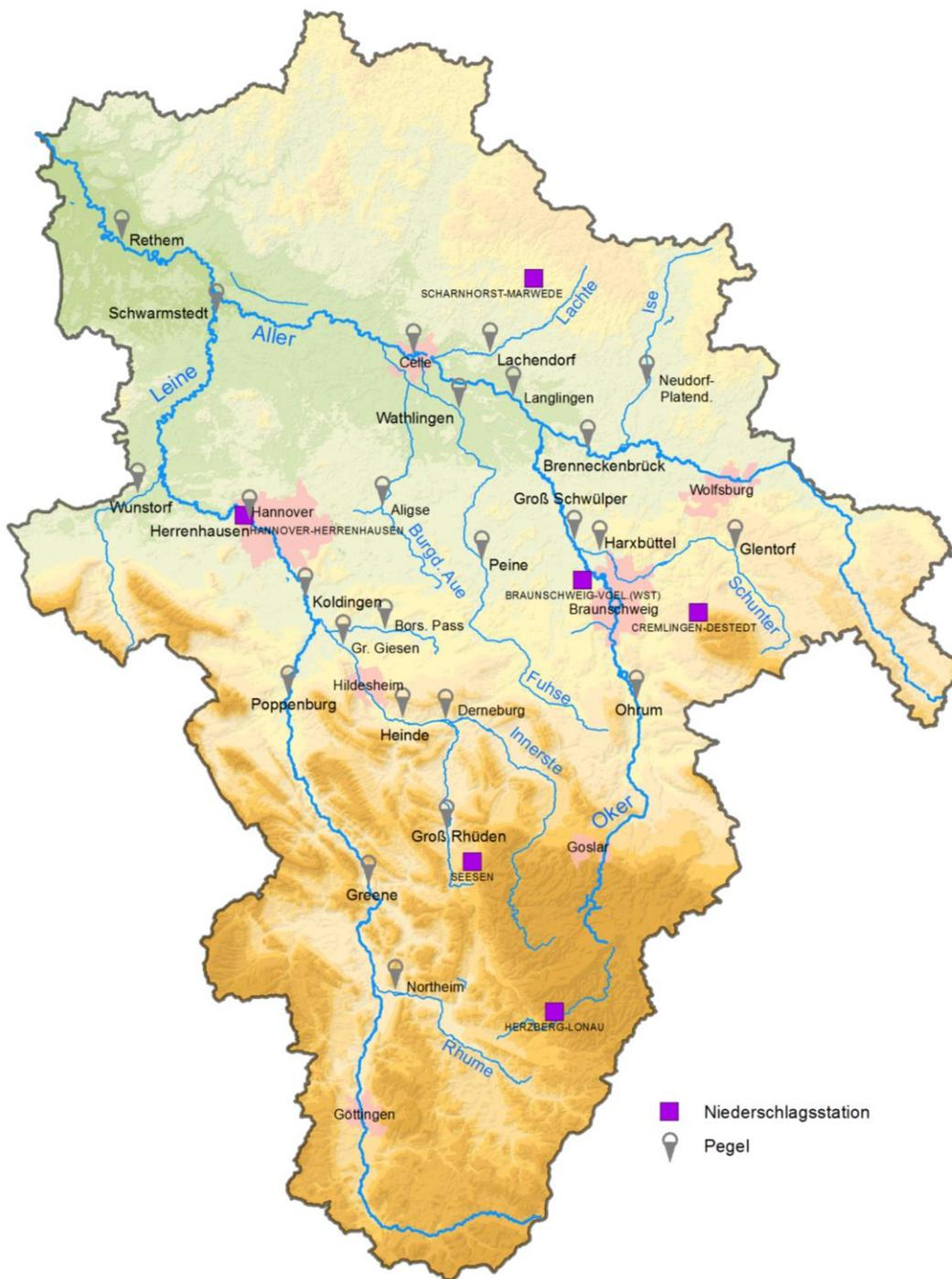
Abbildung 1-2: Einzugsgebiet Aller-Leine-Oker mit den im Text erläuterten DWD-Niederschlagsstationen und Pegeln
