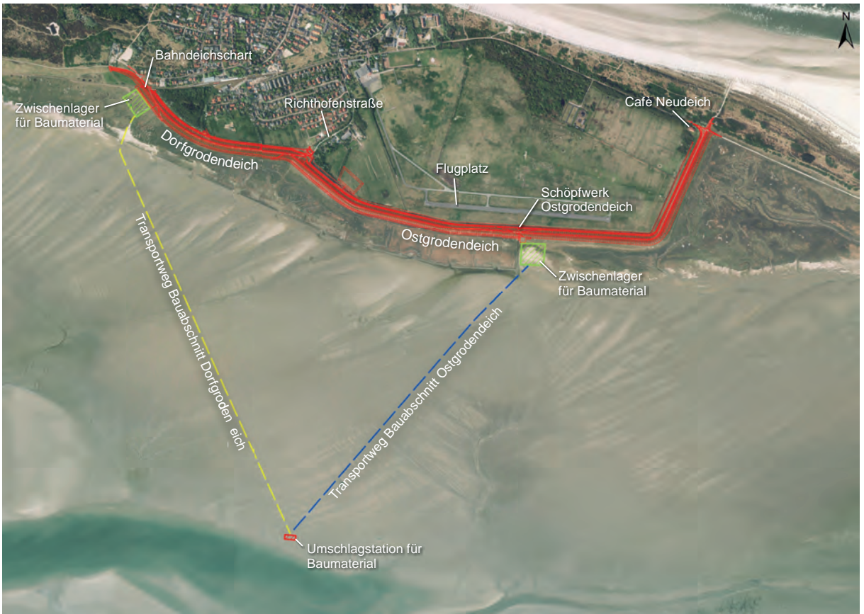
Abb. 5: Lageplan Deichverstärkung und Transportwege im Watt
