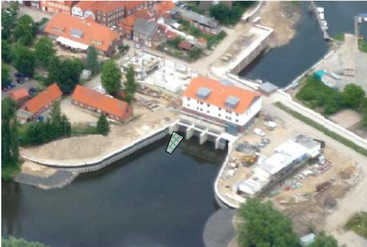
**Abbildung 9: Mögliche Anordnung einer Reuse zum Fang von Fischen, die die Pumpenkammer verlassen (Luftbildquelle: Detailausschnitt aus Abb. 1)**
