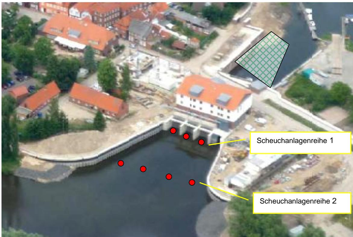
**Abbildung 11: Mögliche Anordnung eines Hamens hinter dem Schöpfwerk zur Erfassung passierender Fische (Luftbildquelle: Detailausschnitt aus Abb. 1)**
