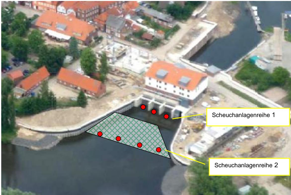
**Abbildung 10: Mögliche Anordnung einer Fangreusentechnik bzw. eines Hamens zur Erfassung passierender Fische der Scheuchanlagenreihe 2 (Luftbildquelle: Detailausschnitt aus Abb. 1)**
