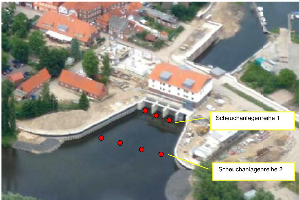
**Abbildung 7: Mögliche Anordnung zweier Scheuchanlagenreihen (Luftbildquelle: Detailausschnitt aus Abb. 1)**
