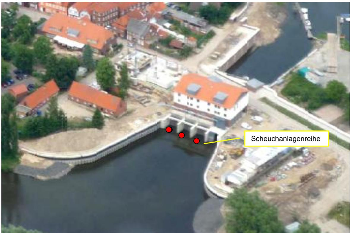
Abbildung 6 : Scheuchanlagenreihe vor den Rechenanlagen(Luftbildquelle: Detailausschnitt aus Abb. 1)
