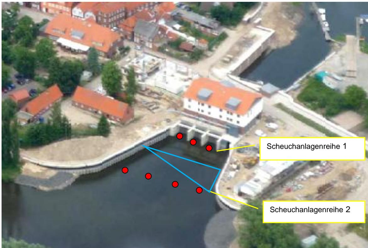
**Abbildung 12: Mögliche Anordnung eines Echolotschallkegels zur Erfassung passierender Fische der Scheuchanlagenreihe 2 (Luftbildquelle: Detailausschnitt aus Abb. 1)**
