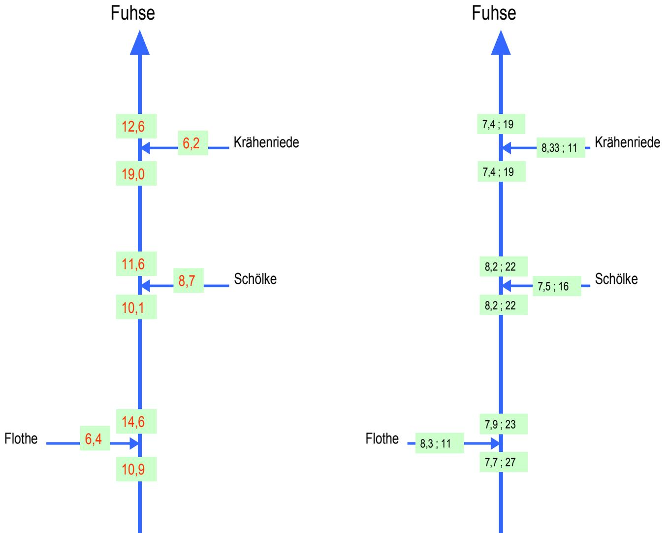
Abbildung 9: Fuhseuntersuchungen mit dem Leuchtbakterientest aus dem Juli 2010: links: prozentuale Leuchthemmung mit Bezug zur jeweiligen abgebildeten Probenahmestelle; rechts: Angaben zu pH-Wert und osmotischem Wert.
