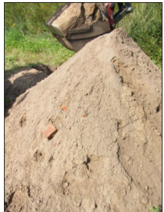
Foto 21+12: Schurf S13 + S16: Sandauffüllungen mit sehr wenig Fremdstoffen
