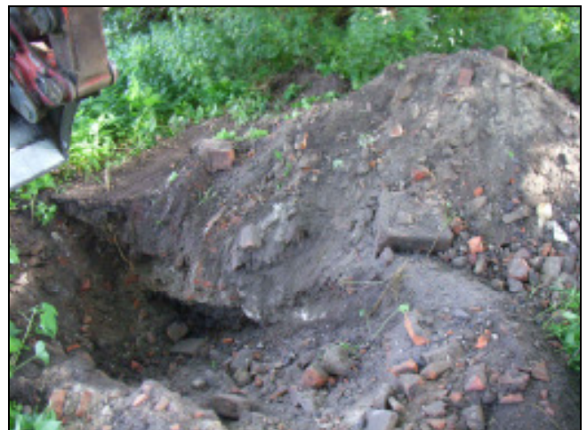
Foto 4: Schurf 6/6A : Bauschuttreiche Altablagerung
