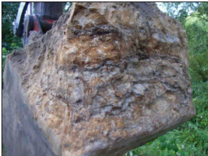
Foto 15: Schurf 44 : Wechsellagerung Sande+Schlufflagen
