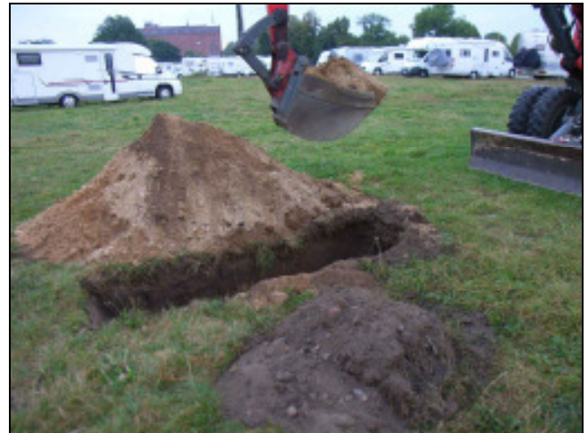
Foto 13: Schurf 17 : Schluffige Feinsand-Auffüllungen; Foto 14: Schurf 21 : Lagenweise wechselnde Sandauffüll.
