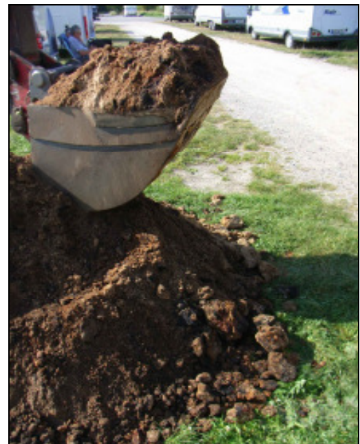
Foto 16: Schurf 19 : Lagen mit Raseneisenstein
