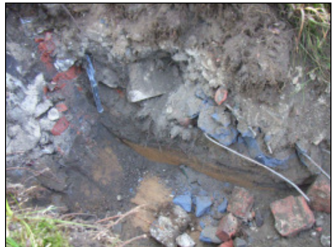
Foto 7+8: Schurf 40A : Flache Altablagerung mit gemischten Baustellenabfällen (Bauschutt)
