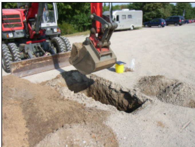
Foto 21+12: Schurf S13 + S16: Sandauffüllungen mit sehr wenig Fremdstoffen
