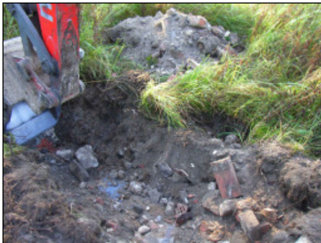
Foto 7+8: Schurf 40A : Flache Altablagerung mit gemischten Baustellenabfällen (Bauschutt)
