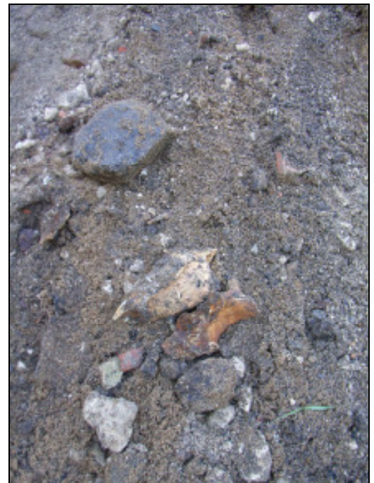
Foto 1+2: Schurf S3 : Altablagerungsmaterial (auffällig: Kohle- u. Schlacke-Anteile, Knochen)
