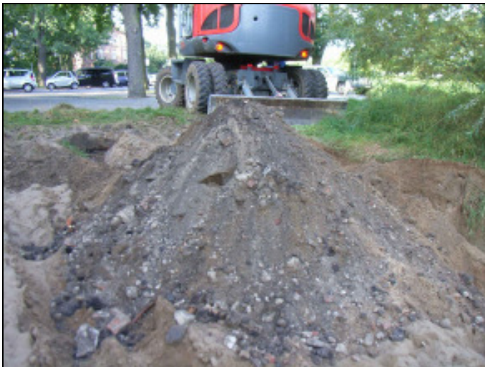
Foto 1+2: Schurf S3 : Altablagerungsmaterial (auffällig: Kohle- u. Schlacke-Anteile, Knochen)
