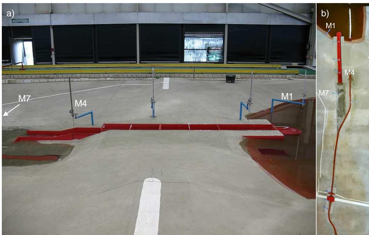
**Abb. 3.1: Fotografien des physikalischen Modells aus (2006) mit Lage der Stechpegel M1, M4 und M7.**
