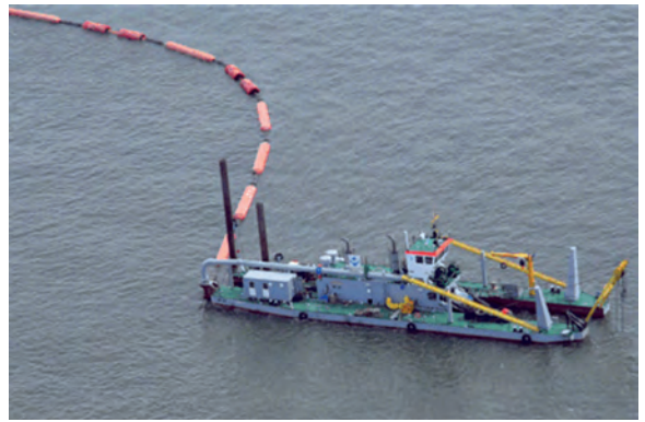
Abb. 3: Schneidkopfsaugbagger mit Spülleitung
