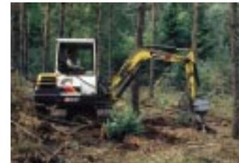
Abbildung 10: Das LoBo-Gerät an einem Minibagger
