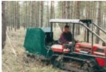
Abbildung 7: Das Kullagerät an einer Schmalspurraupe
