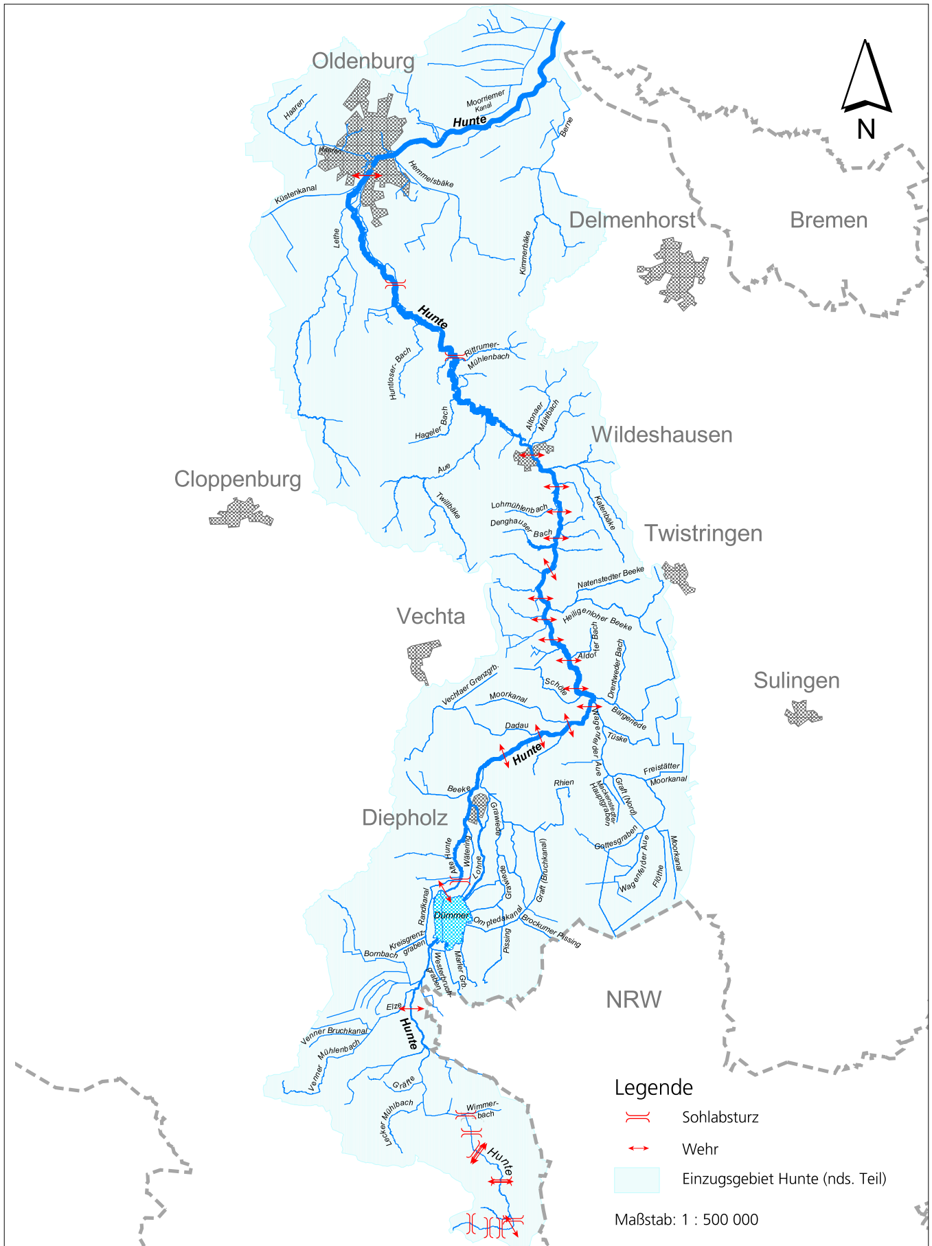
Abbildung 4: Querbauwerke in der Hunte
