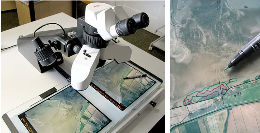
Abb. 2.3: Luftbildauswertung am Stereoskop - Übertragen der Bestandsgrenzen auf Folie
