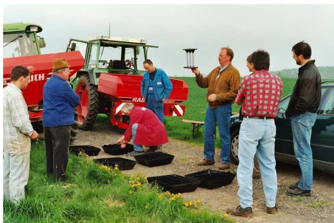
Abb. 7: Düngerstreuercheck zur Optimierung der Verteilgenauigkeit von mineralischem Stickstoffdünger
