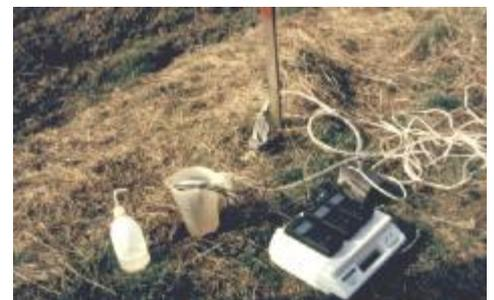
Abb. 3: Probenahme aus einer Messstelle. Messung von pH-Wert, elektrischer Leitfähigkeit, Sauerstoffgehalt und Temperatur im Durchfluss.
