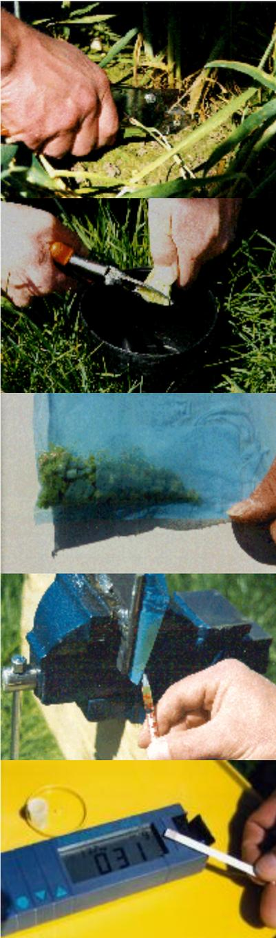
Abb. 3 bis 7: Probenahme, Presssaft-Gewinnung und  $NO_3$ -Gehaltsmessung mit dem Nitrachek-Gerät
