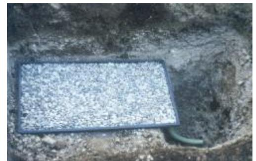
Abb. 3: Lysimeter mit Kiesschüttung; recht ist die tieferliegende Grube für den Auffangkanister erkennbar.
