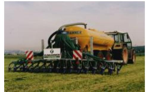
Abb. 2: Gleitfußverteiler
