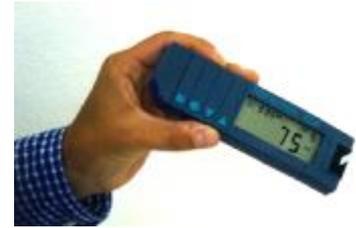
Abb. 2: Nitrachek-Gerät für die  $\text{NO}_3^-$ -Gehalts-Bestimmung mit Teststreifen
