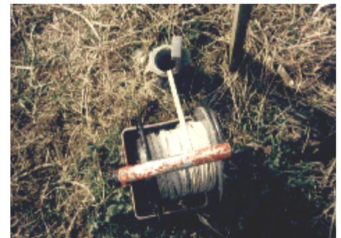
Abb. 2: Grundwasserstandsmessung in der flach verfilterten Messstelle mittels Kabellichtlot
