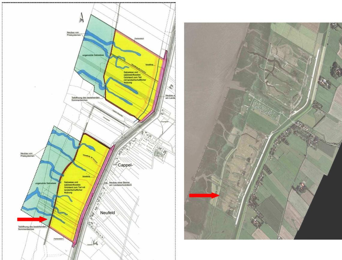
**Abbildung 130:** links: Planung zum Rückbau von Sommerdeichen und Bau von Prielsystemen an der Wurster Küste; rechts: Luftbild 2008 nach Herstellung der Priele
