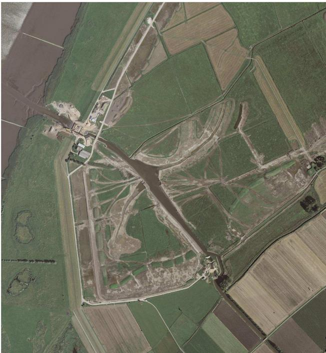
**Abbildung 135:** Bau eines sperrwerksgesteuerten Tidepolders mit Prielen auf der Luneplate südlich von Bremerhaven (Bauzustand 2008)
