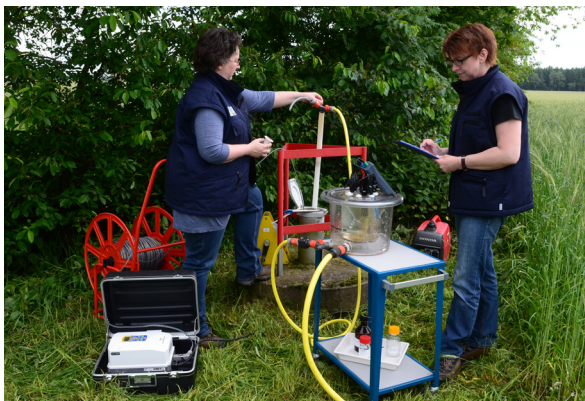
Probenahme an einer Grundwassermessstelle
