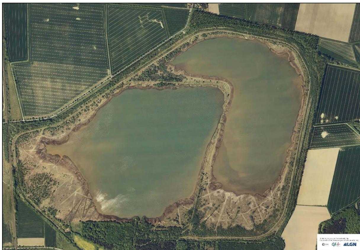
**Abbildung 2:** Luftbild des Heerter Sees mit Blick auf den Mitteldamm, der den See in einen nordöstlichen und südwestlichen Teil trennt. Durch eine Passage im Damm sind die Wasserkörper beider Seebecken jedoch verbunden.
