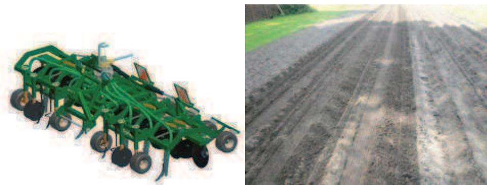
**Abbildung 8** Gülleinjektor PreMaister der Firma Kotte Landtechnik (links) und Arbeitsbild des Prototypen (rechts), Fotos: Firma Kotte
