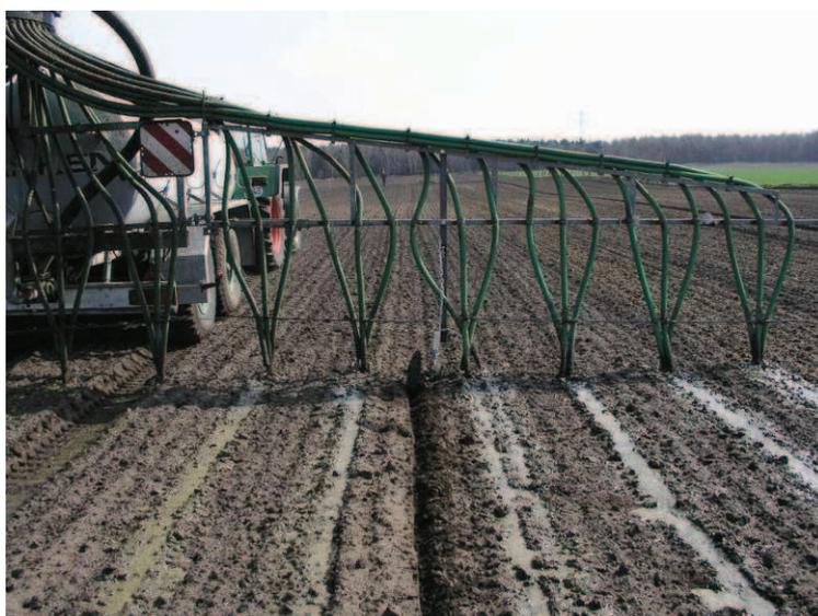
**Abbildung 3 Schleppschlauchverteiler zur Bandablage 2006**
