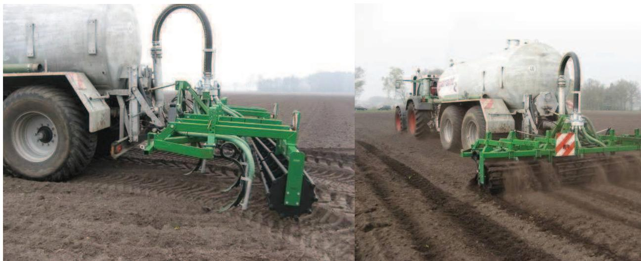
**Abbildung 7** Güllegrubber zur Gülleausbringung 2008 mit der Bandablage (links) und der Gülleinjektion (rechts) im Vergleich
