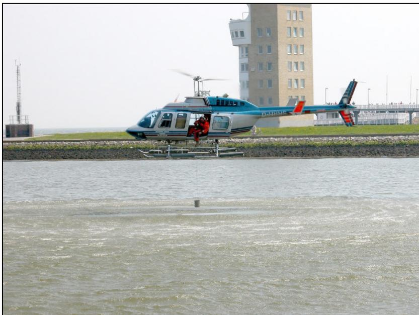
Abb. 2: Probenahme im Küstenbereich mittels eines Helicopters
