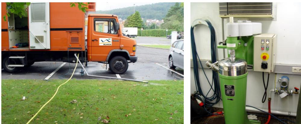
Abb. 1: Probenahmefahrzeug und Durchlaufzentrifuge (Fa. Padberg, Typ Z61)
