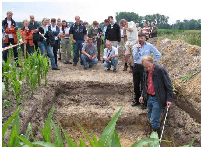
Besichtigung der Demoanlage Gülleunterfußdüngung – Ansicht eines Bodenprofils
