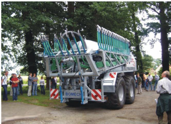
Besichtigung eines Schleppschuhverteilers auf dem Betrieb von Herrn Schwarte
