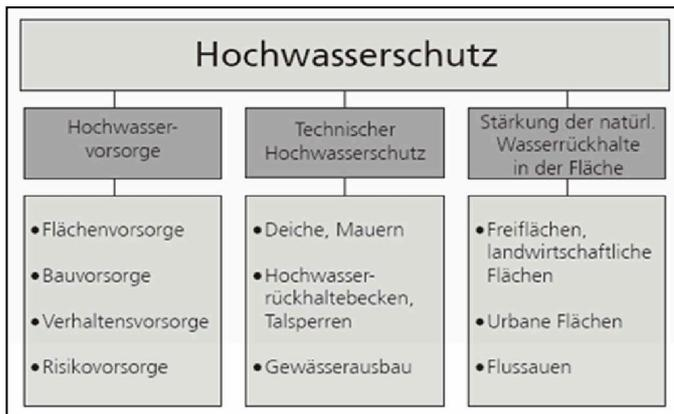
Abb. 13: Drei-Säulen-Modell des modernen Hochwasserschutzes
