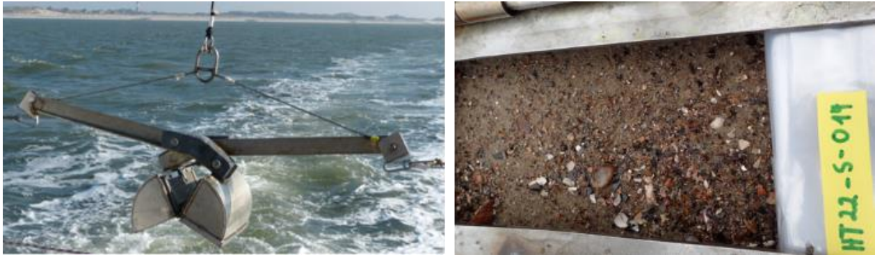
Abb. 21: Backengreifer zur Sedimentbeprobung (links) und Sedimentprobe (rechts).
