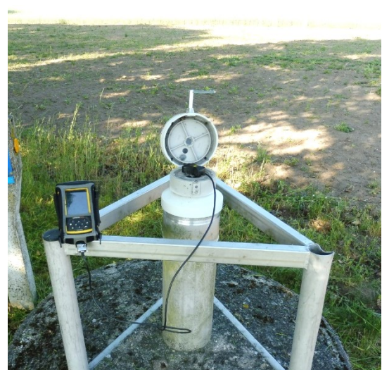
Abb. 43: Grundwasserstandsmessung mit Drucksonde, Datenspeicherung über Datenlogger, Datenübertragung durch Datenfernübertragungssonde (DFÜ).
