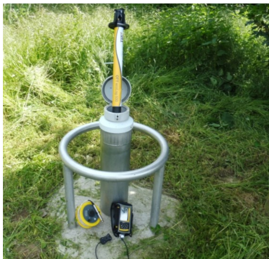
Abb. 42: Grundwasserstandsmessung mit dem Lichtlot.
