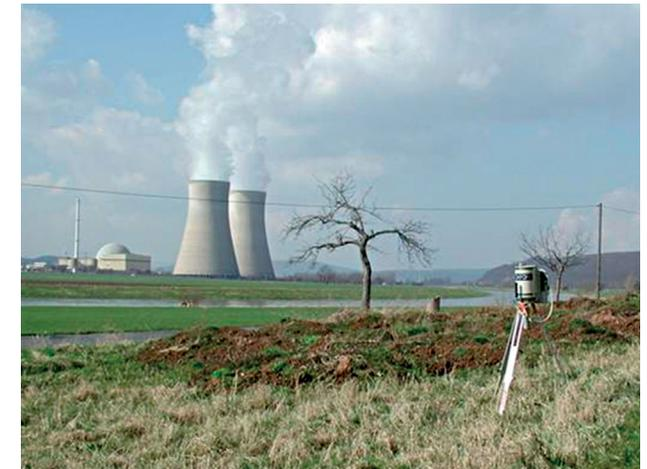
Messung der Gammastrahlung am KKW Grohnde
