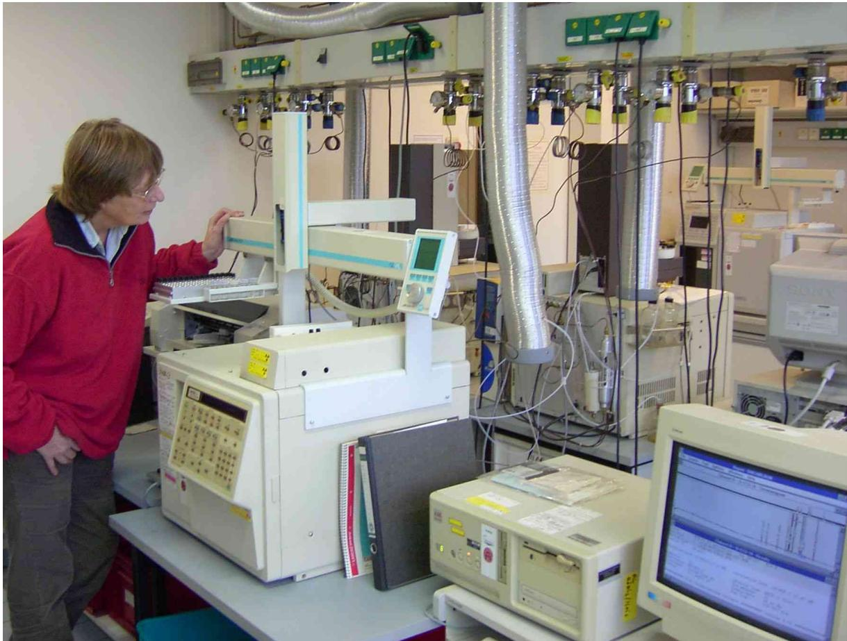
**Foto: Untersuchung auf organische Stoffe mittels eines Gaschromatographen (GC)**
