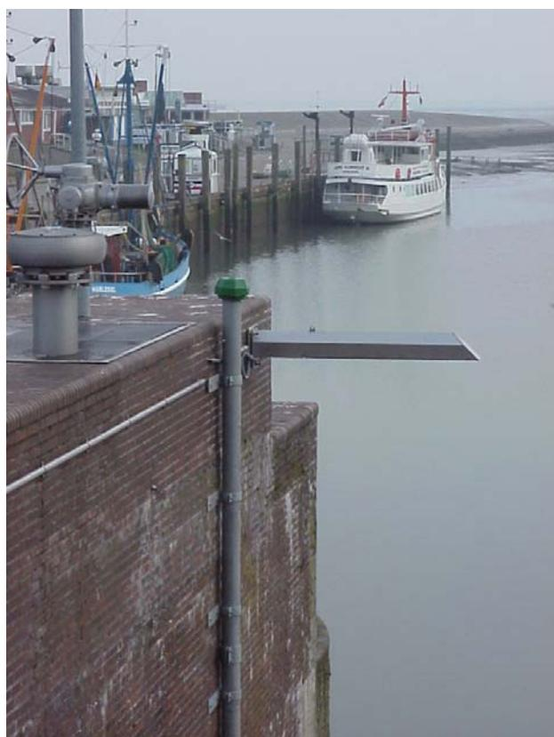
Horizontal montierter Radarpegel Harlesiel (Messsignal gespiegelt)
