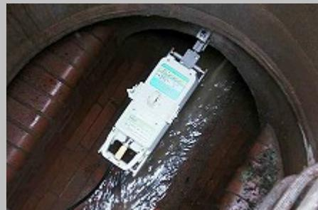
Seitens des Geräteherstellers Ott, Kempten, wurde 2002 berichtet, dass in schnell fließenden Gebirgsflüssen Versuche zur Messung der Fließgeschwindigkeit an der Wasseroberfläche mit dem Radarsensor KALESTO erfolgreich durchgeführt wurden.
