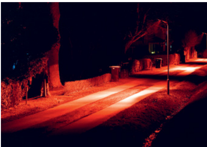
Abb. 50: Spezielles rotes Licht bescheint nur die wichtigsten Strukturen an einer Straße in Ahrenshoop, Mecklenburg-Vorpommern. Das Projekt soll die Lichtverschmutzung am Bodden reduzieren. Auch in Hannover wird im Rahmen des Projekts Smart.Light mit innovativen Technologien erprobt, wie öffentliche Beleuchtung sowohl Sicherheit für Menschen gewährleisten, als auch gleichzeitig die Auswirkungen künstlicher Lichtquellen auf die Umwelt reduzieren kann. (Foto: J. Büttner/picture alliance/dpa)
