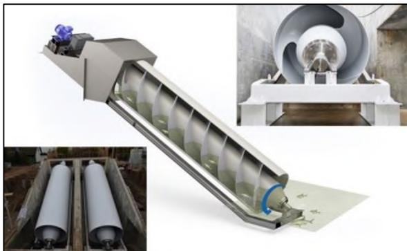
**Abbildung 108: Fischschonende Pumpe Fish-Flow-Innovations (FFI)-Schneckenpumpe (beachte die angeschrägten Eintauchblätter (Bild oben rechts) und den Vollmantel (Bild unten links) (<http://fishflowinnovations.nl/innovaties/vijzelgemaal/> in FINCH 2022).**
