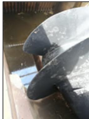
**Abbildung 107: Herkömmliche Schneckenpumpe mit fischschädigenden Elementen: Spalt zwischen Mantel und Schnecke sowie senkrecht zur Achse stehendes Eintauchblatt (FINCH 2023).**
