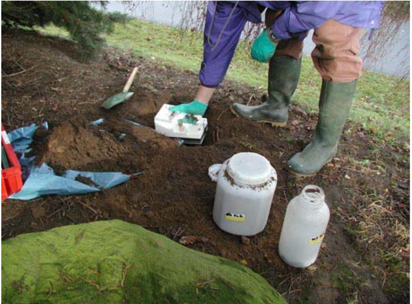
Abb. 4: Kontaminationsmessung des NLÖ mit Großflächenzähler
