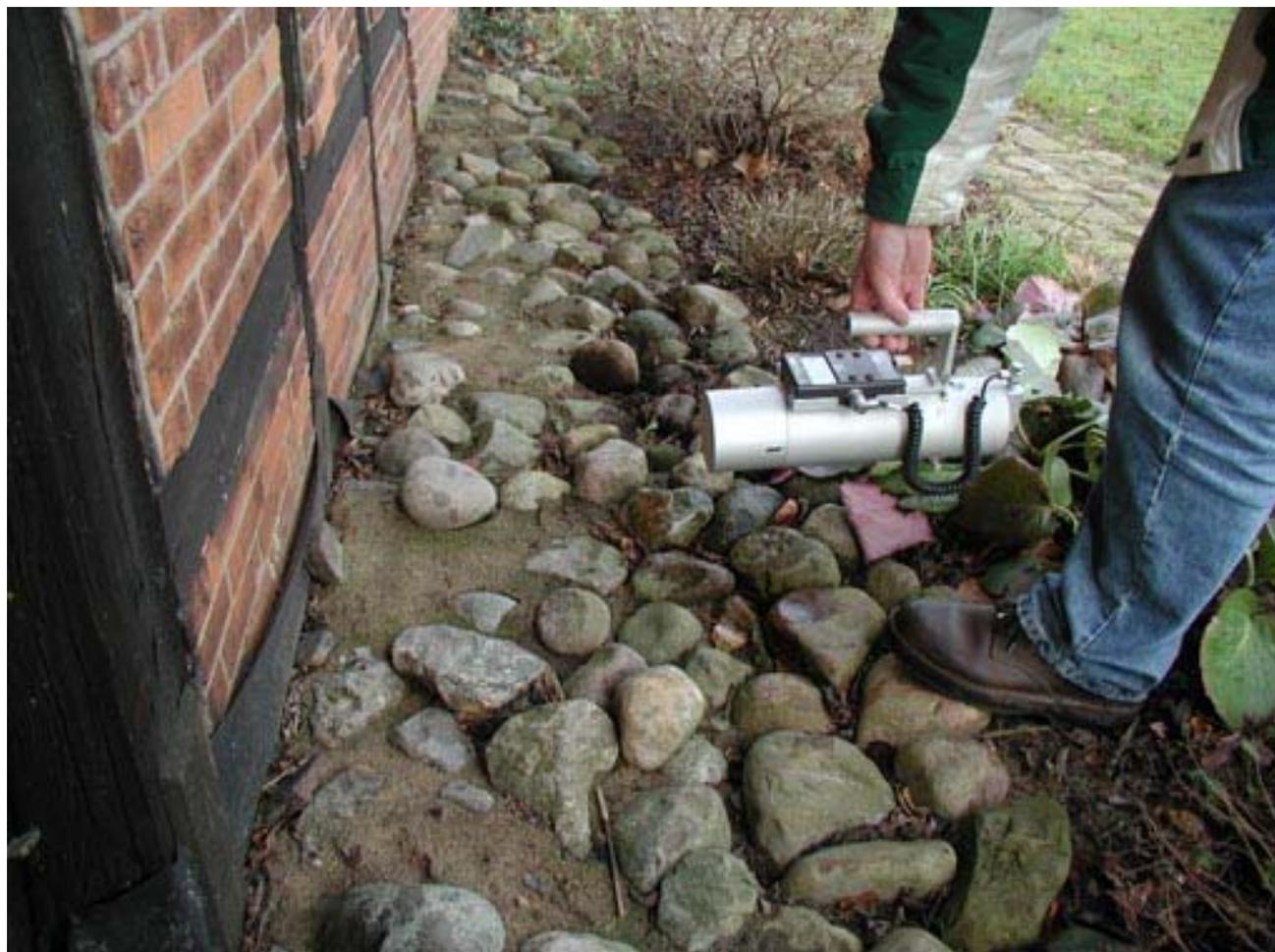
Abb.1 Dosisleistungsmessung des NLÖ, Probenahmestelle Abtropfstelle Reetdach.
