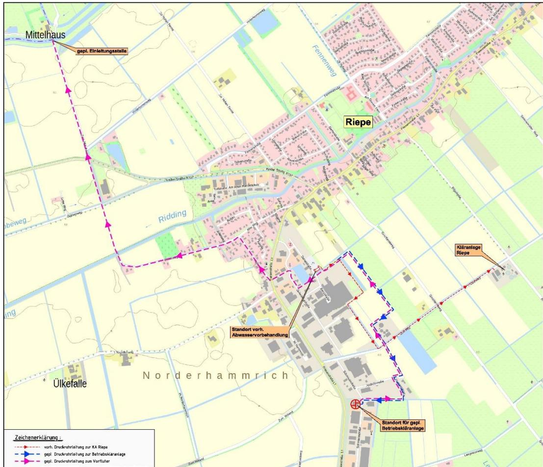
Abbildung 5.4: Standortsituation mit geplanten Druckrohrleitungen vom Produktionsbetrieb/Abwasservorbehandlung zur Betriebskläranlage und zum Ems-Jade-Kanal
