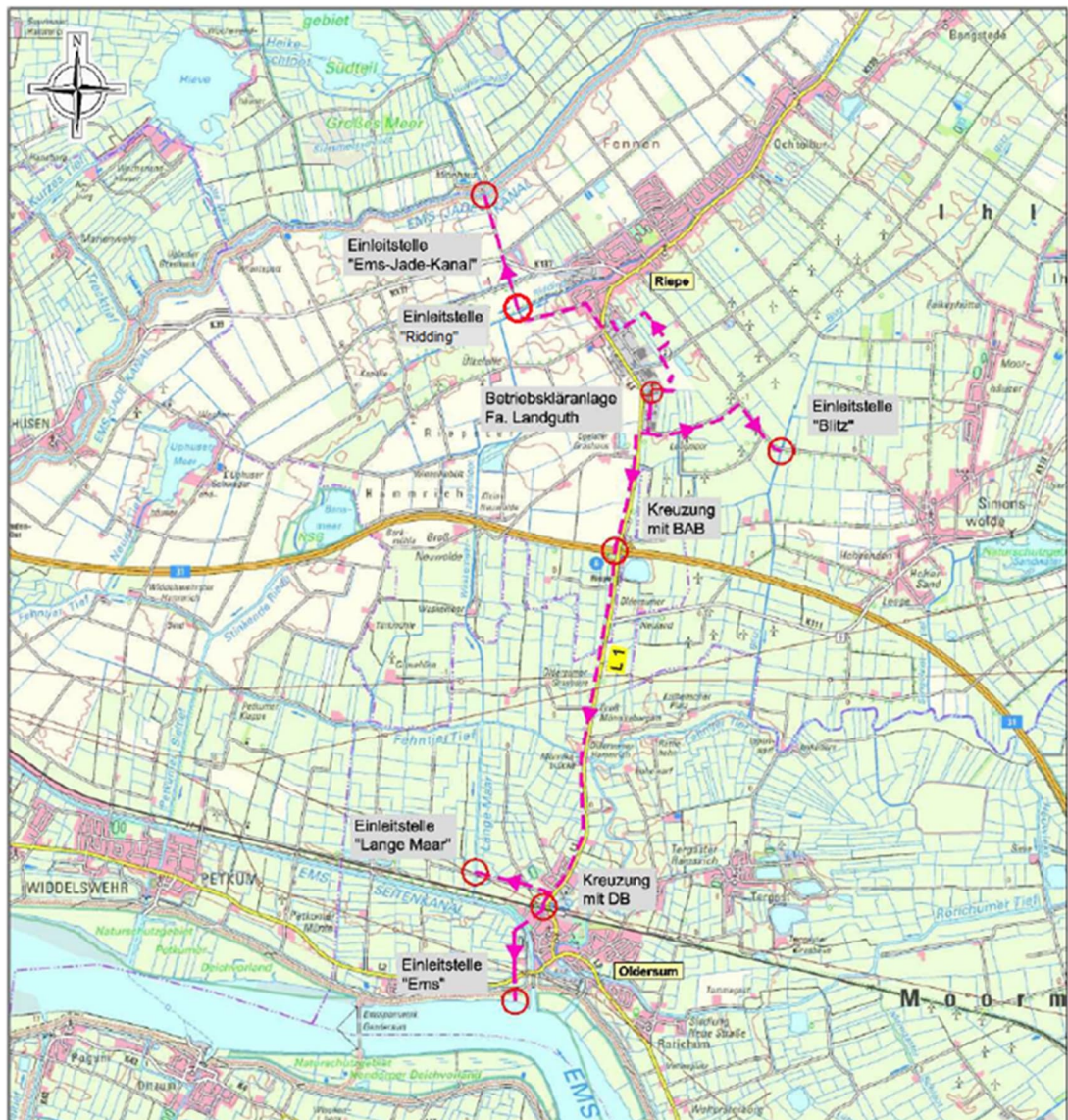
Abbildung 0.1: Standort der geplanten Betriebskläranlage und mögliche Einleitgewässer
