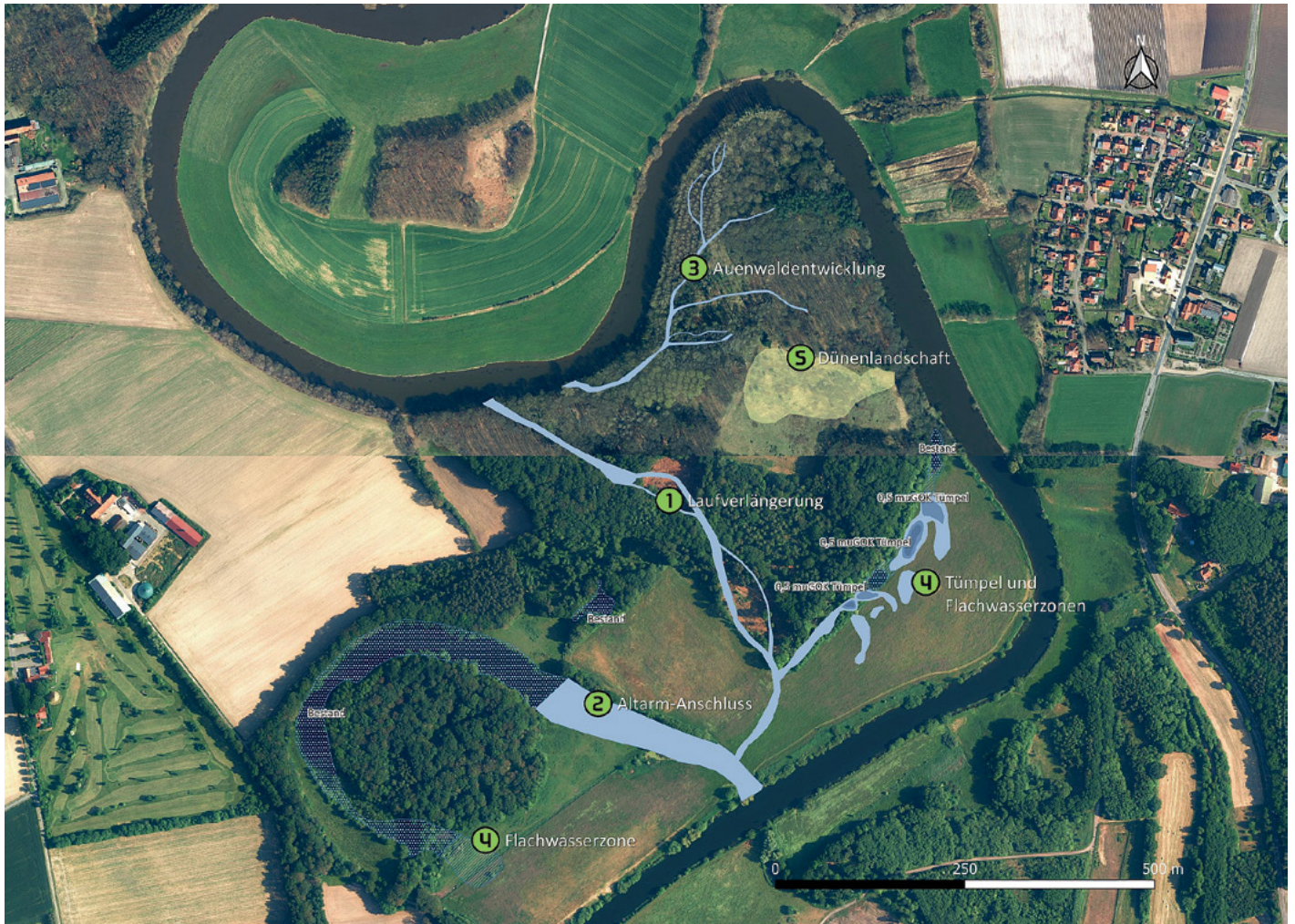
Abb. 5: Maßnahmenbeispiel aus dem Projekt EmsLand: Altarmanschluss, Anlage einer Flussinsel und Auenwaldentwicklung an der Mehringer Heide (Quelle: N. Gepp)
