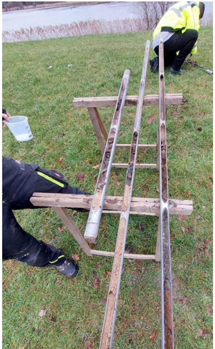
Abbildung 31: Bohrkern der Kleinrammbohrung in Tespe;
