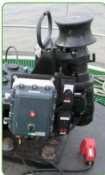
Abbildung 4-8: QRH mit integrierter Capstan-Winde
