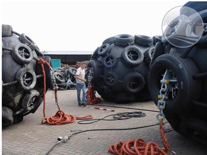
Abbildung 4-12: Beispiel pneumatischer Fender
