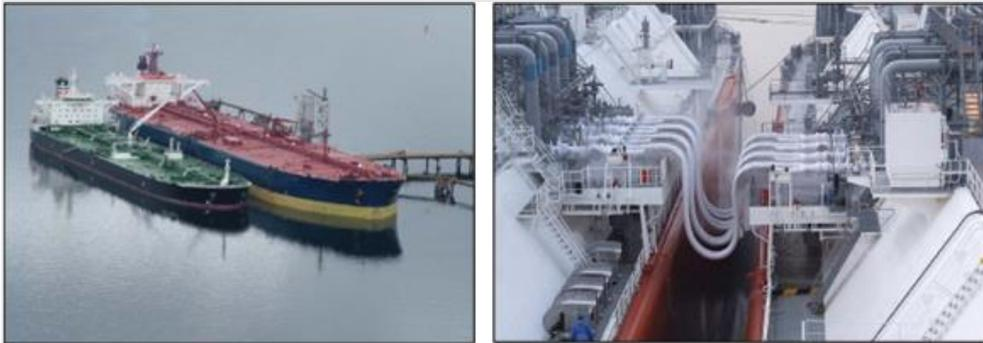
Abbildung 4-10: Double Banking (links) LNG STS Transfer (rechts) Quelle: STS-Transferleitfaden (CDI/ICS/OCIMF/SIGTTO)
