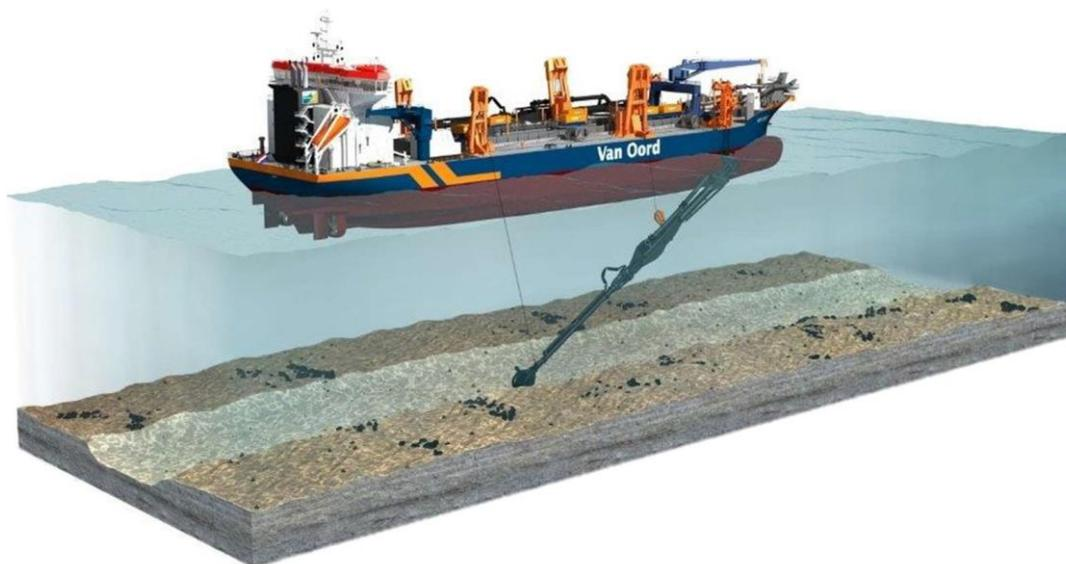
Abbildung 14 Arbeitsschiff zum Herstellen der Liegewanne und des Zufahrtbereiches (Beispiel)
