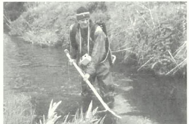
Abb. 14: Die Elektrofischerei bietet in kleinen Fließgewässern eine gute Möglichkeit, um die Fischfauna zu erfassen. Dabei werden Probestrecken gegen die Strömung watend befischt. Im elektromagnetischen Feld werden die Fische betäubt. Sie können dann mit dem Kescher entnommen und bestimmt werden.
