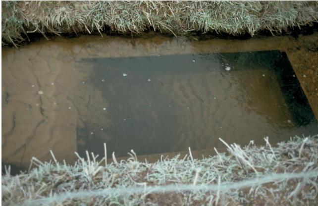
Abb. 1: Sandfang im Endeholzer Graben zur Messung der Feinsedimentfrachtmenge. In der oben offenen Holzkiste (Maße: 2 m lang, 1 m breit, 0,5 m tief) sedimentieren der überwiegend am Gewässergrund rollend transportierte Sand sowie organisches Material, das zur Mengenbestimmung herausgenommen werden kann. Typisch für den übermäßigen Sedimenttransport sind die Sandribbeln (links im Bild zu sehen), die eher an Sandstrände an der Nordseeküste erinnern, als an einen natürlichen Heidebach.
