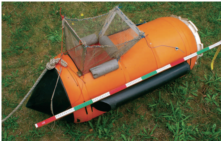
Abb. 1: Forellenbox in Seitenansicht. Hergestellt aus drei ineinander gesteckten Tonnen. Aus der mittleren und hinteren Tonne wurde der Boden herausgetrennt, aus der mittleren und vorderen Tonne das Oberteil mit dem Gewinde. Auf den Boden der vorderen Tonne wurde zur Verbesserung der Stromlinienform ein Kegel aufgeschweißt (im Bild links). Seitlich sind Schwimmer angeschweißt, die auch bei schwierigen Verhältnissen mit vielen überhängenden Zweigen den Transport kaum behindern. Zum besseren Einfüllen der Forellen wurde um das Einfüll-Loch ein einklappbarer Trichter angebracht. Dieser verhindert eingeklappt das Entweichen von Forellen z. B. beim Übersetzen über quer liegende Bäume.
