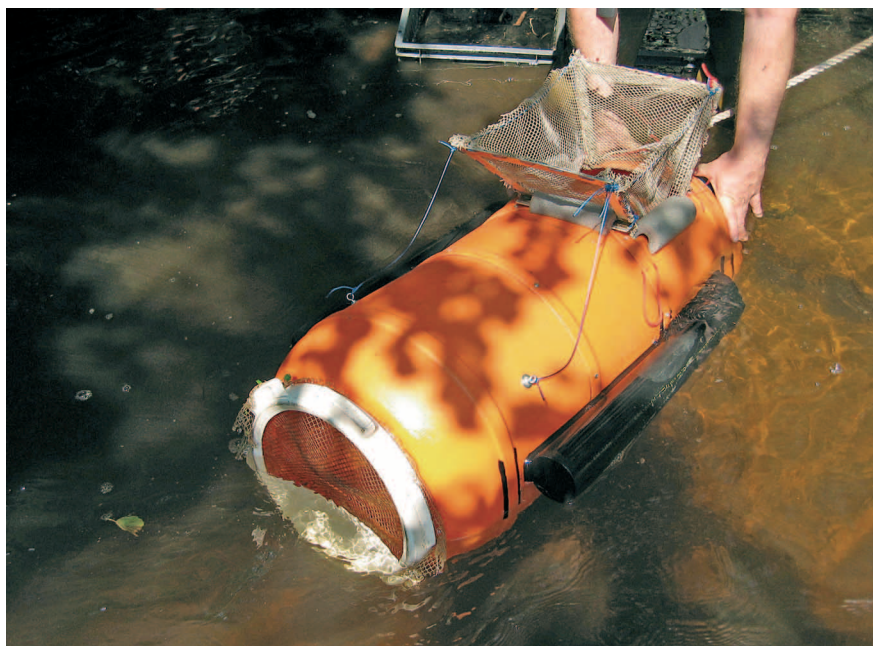
Abb. 2: Hinteransicht der Forellenbox mit dem aufgeschnittenen Schraubdeckel. Man kann die Möglichkeit für einen freien Wasseraustausch zwischen Forellenbox und Bach sehr gut erkennen. Das vom aufgeschraubten Deckel eingeklemmte Netz verhindert das Entweichen der Fische. Die im aufgeschnittenen Deckel belassene Kante verhindert das Auslaufen des gesamten Wassers in sehr flachen Gewässerabschnitten. Die Fische werden durch das 20 x 20 cm große Loch an der Oberseite der Forellenbox am vorderen Ende eingegeben. Der einklappbare „Trichter“ verringert den Fischverlust beim Hineinschütten mit dem Käscher erheblich. Auf die harten Innenkanten der Einfüllöffnung sind Schaumstoff-Isolierschläuche aus dem Heizungsbau gesteckt, um eine Verletzung der Fische zu vermeiden.
