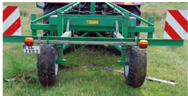
Abb. 6 u. 7: Einsatz eines Horizontalunterschneidungsgerätes, rechts kurz vor dem Einführen in den Boden (Fotos: G. Lange)
