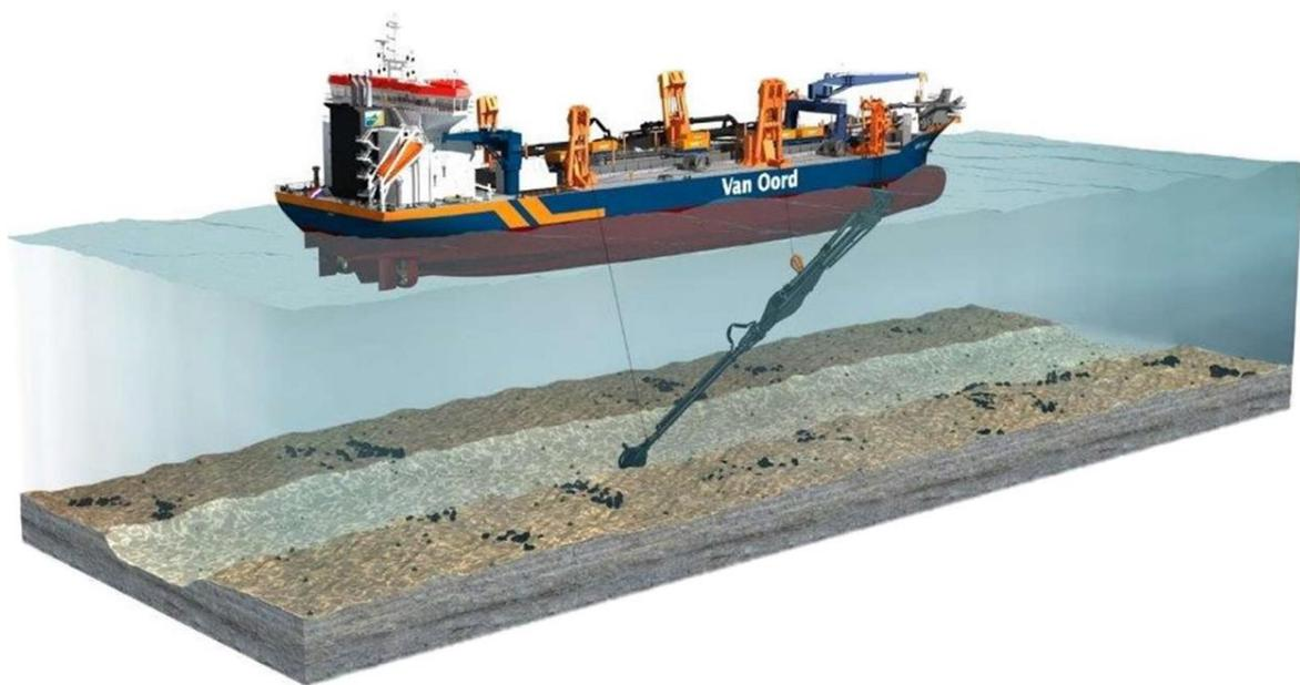
Abbildung 11 Schleppsaugbagger (TSHD Trailing Suction Hopper Dredger)
