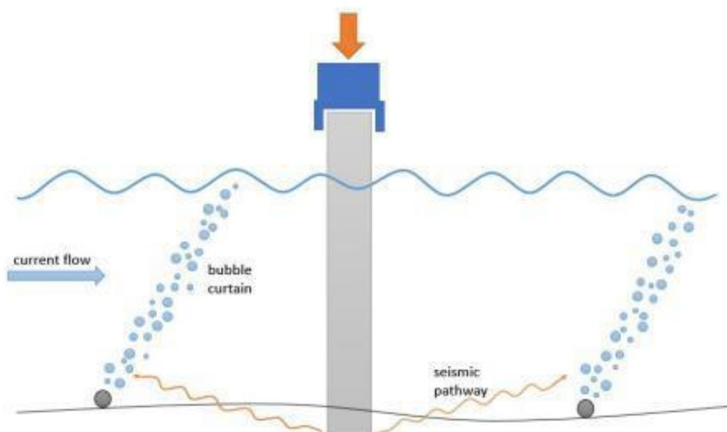
Abbildung 2 Funktionsprinzip eines Blasenschleiers (Wagenknecht, 2021)
