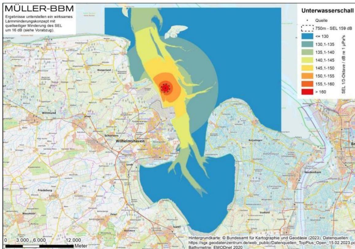
Abbildung 1 Immissionsprognose für Dalbengründung  $D = 4,5\text{ m}$  Minderung SEL - 16dB
