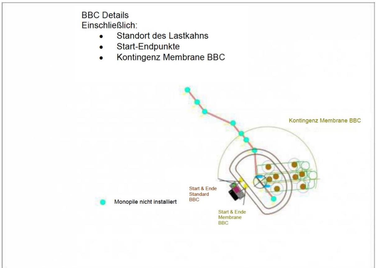
Abbildung 4 BBC-Details mit drittem Membranschlauch als zusätzliche Schallminderungsmaßnahme im Bedarfsfall (Jaeger Maritime Solutions, 2023)
