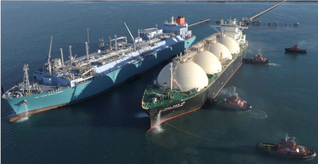
Abb. 2: Anlegen eines Tankschiffs an die FSRU (Beispiel)
