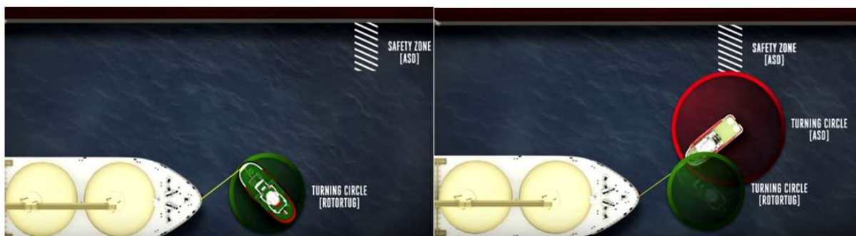
Abb. 39: Vergleich Drehkreis Rotortug und ASD-Schlepper
