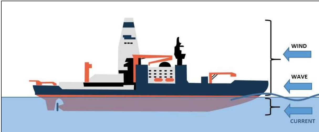
Abb. 41: Auftretende Kräfte beim Schleppvorgang
