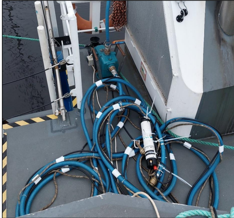
Abbildung 2-7: Wasserpumpe zum Entnehmen von Wasserproben, ausgestattet mit einem OBS-3A nahe des Wasserschlaucheinlasses.
