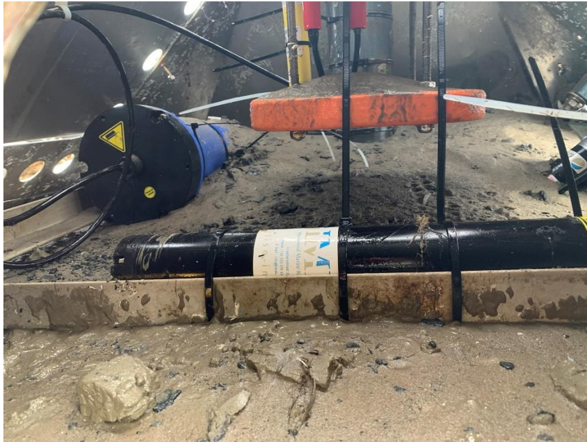
Abbildung 3-3: Sand auf dem Boden des Meeresbodengestells, wie nach dem Einholen des Gestells am 31.03.2023 festgestellt.
