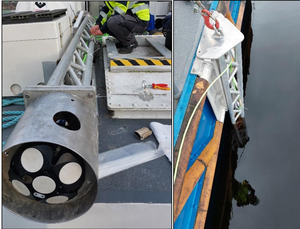
Abbildung 2-5: Am Gestell des Untersuchungsschiffes montierter ADCP (links); an der Seite des Untersuchungsschiffes für mobile Messungen angebrachter ADCP (rechts)
