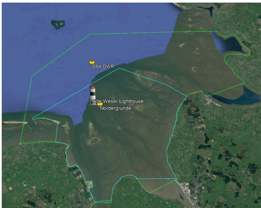
Abbildung 17: Umrisslinie des grundlegenden Wellenmodells (türkis) und des erweiterten Wellenmodells (grün).
