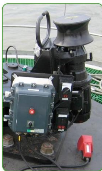
Abbildung 4-8: QRH mit integrierter Capstan-Winde
