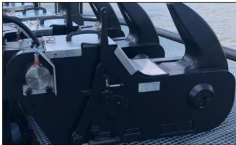
Abbildung 4-9: Festmacher-Lastüberwachungssystem und Wägezelle
