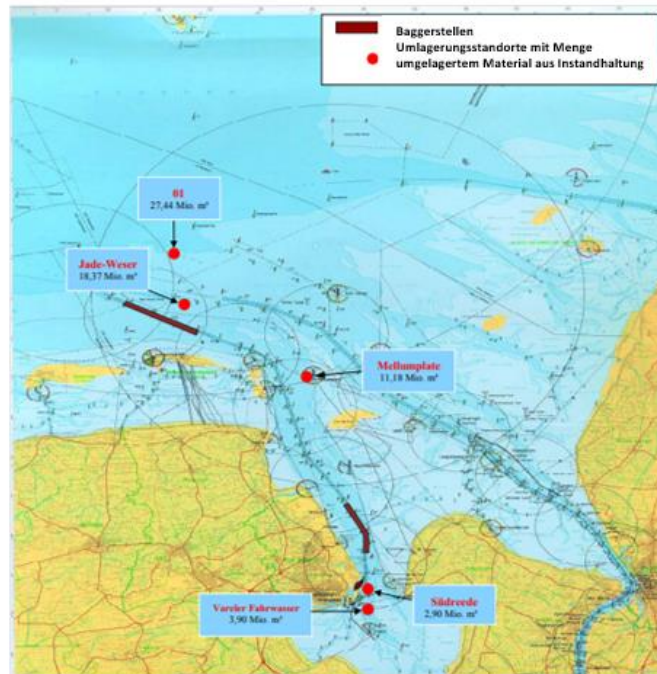
Abbildung 5-16: Positionen der Bagger- (rote Linien) und Umlagerungsflächen (rote Punkte) im Jadegebiet. (Quelle: Stand der ökologischen Bewertung von Ausbaggerungs- und Umlagerungsstandorten in Deutschland und den Niederlanden, Dezember 2006)
