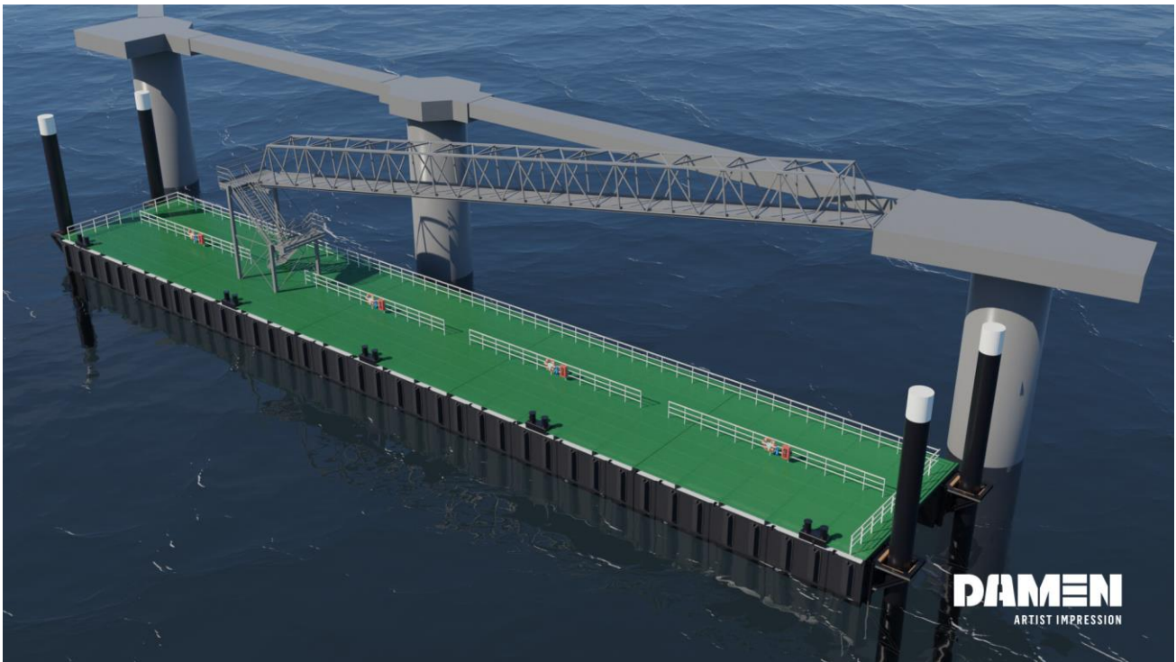
Abbildung 7-8: Ponton nahe MD5 und MD6 mit Laufweg/Rampe zu Ponton MD6 (Quelle: DAMEN)
