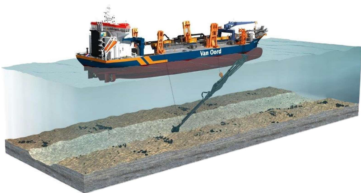
Abbildung 21: Arbeitsschiff zum Herstellen der Liegewanne und des Zufahrtbereiches (Beispiel)
